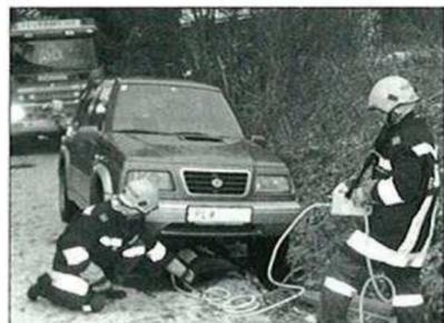
Mit den neuen Hebekissen vom Tanklöschfahrzeug, wurde ein, mit dem Vorderrad in einen Betonschacht gestürzter PKW gehoben und wieder auf die Fahrbahn gestellt. Aufgrund dieser schonenden Bergungsmaßnahmen blieb
